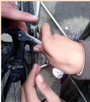
Au niveau de la poignée du guidon, appuyer comme pour freiner pour faire sortir le câble à l'aide d'un tournevis.
